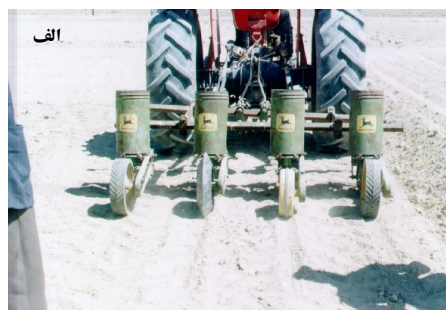
شکل ۵- الف: ایجاد ترک در محل خطوط کاشت بوسیله چرخ‌های مخروطی شکل، ب: چرخ فشار در ردیف کار چغندر قند
